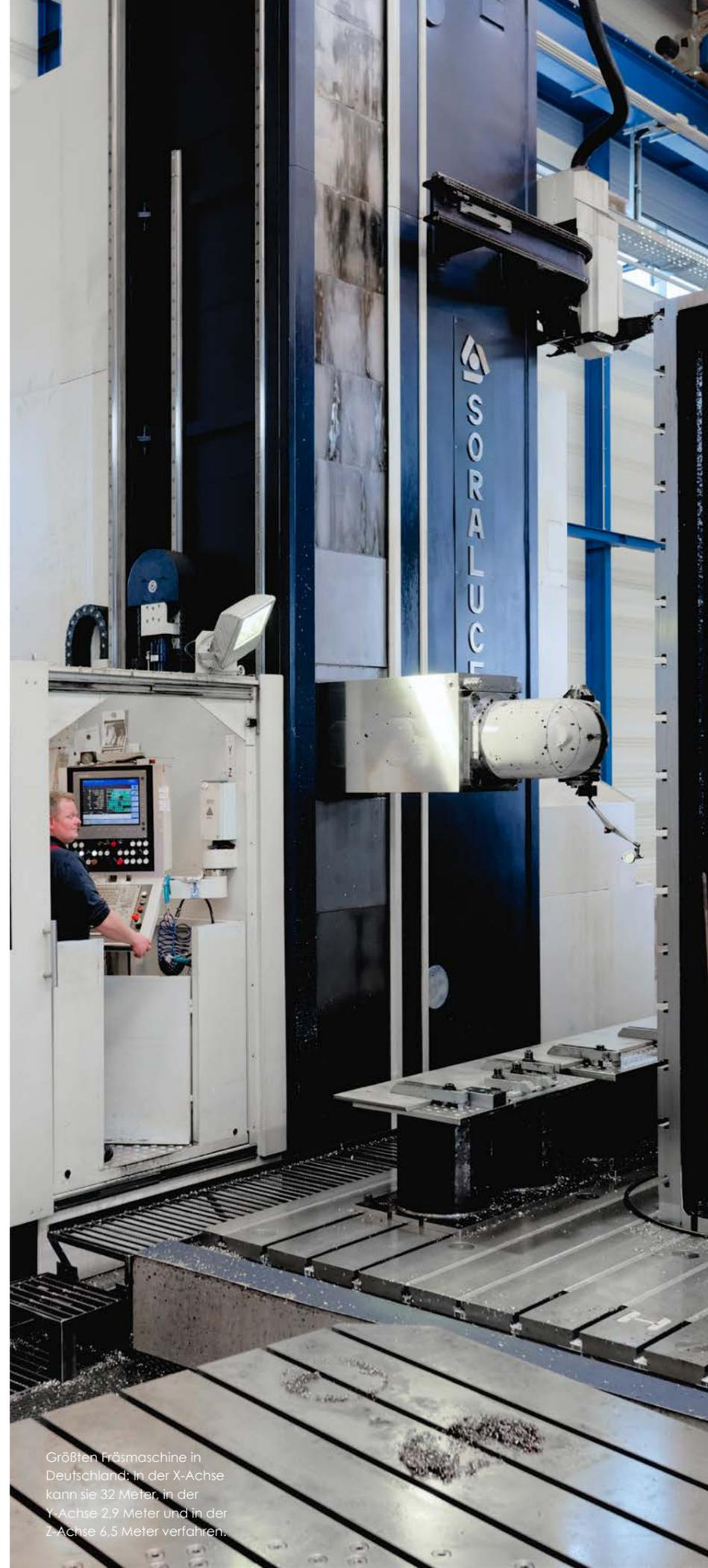
Größten Fräsmaschine in Deutschland: In der X-Achse kann sie 32 Meter, in der Y-Achse 2,9 Meter und in der Z-Achse 6,5 Meter verfahren.
